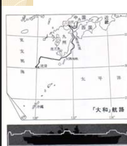
「大和」の艦隊司令部の航路図 左舷側（艦首） 右舷側（艦尾） 排水量（満載） 72,000トン 全長 263メートル 全高 200メートル 最大速力 27ノット 航続距離 7,000海里
